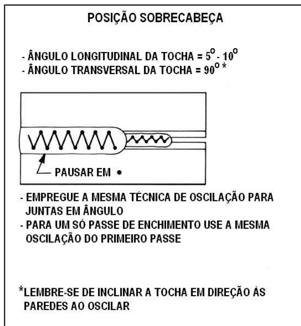
Figura 38 - Manipulações da tocha na posição sobrecabeça
